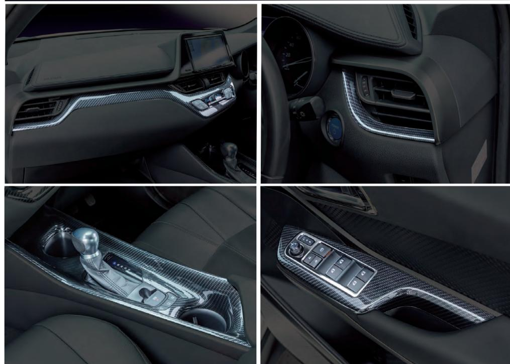
インテリアパネル 材質樹脂(カーボン調) インパネ、センターコンソールスイッチベースへ設定 計7枚
